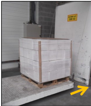
Figure 3: horizontale impactttest uitgevoerd op de schommel
