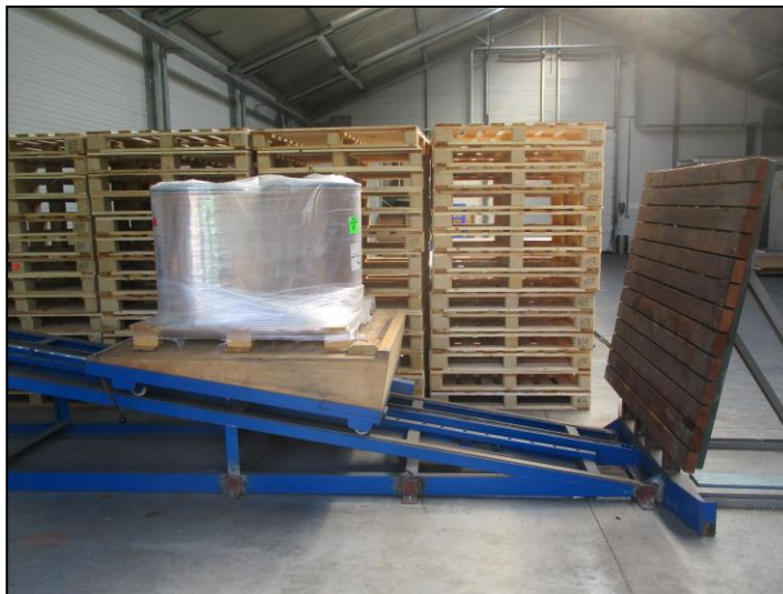
Foto 3 impact test op gepalleteerde lading met gebruik van hellend vlak
