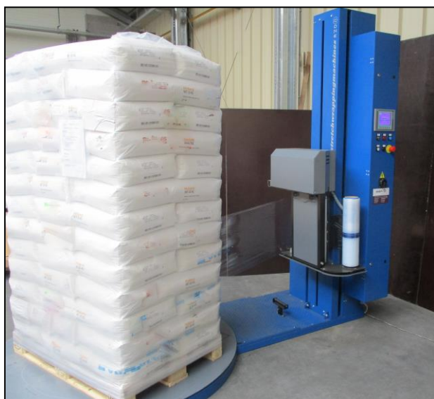
Foto 4: Halfautomatische draaitafel palletwikkelaar Type C-One Base+ PPS Voorrek en toevoersnelheden zijn afzonderlijk instelbaar!
