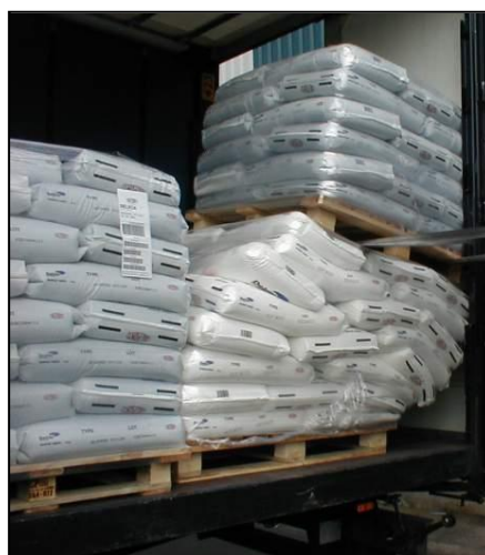
Foto 1: Verschuiven van de lading op de pallet
