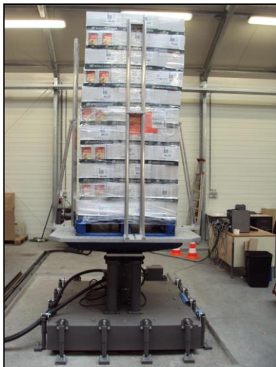
Foto 2: Hoogfrequente vibratietest op gepalleteerde lading
