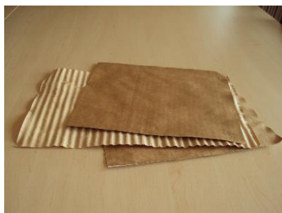
Een vel golfkarton ontleed: buitenlaag, golflaag, binnenlaag
