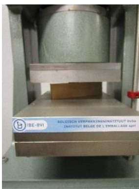
Metten van de ECT-waarde op een testmonster van 10 x 2,5 cm
