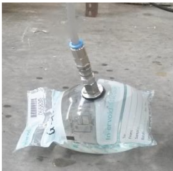
interne hydraulische druktest op een seal bag
